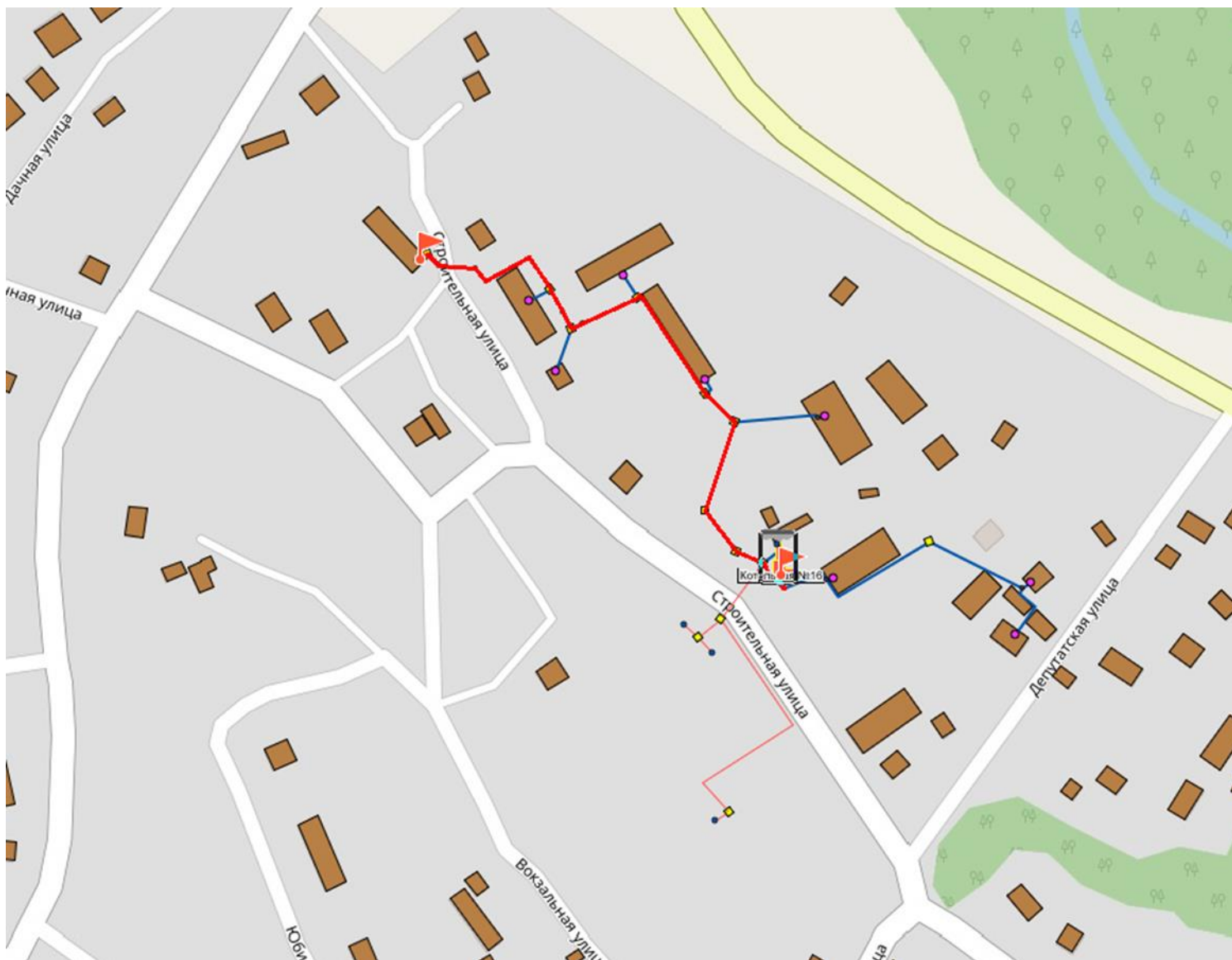
Рисунок 14 – Путь построения пьезометрического графика от Котельной №16 (пгт. Ноглики) до определяющего потребителя – МКД (пгт. Ноглики, ул. Строительная 43)
